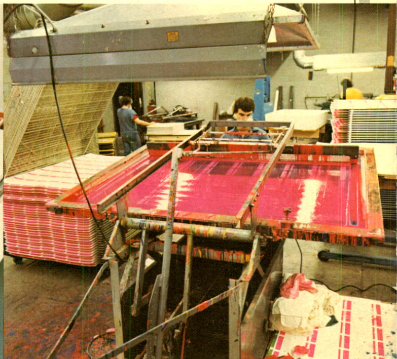
Dans les services d'étalage Cantire, une machine à sérigraphier automatique facilite la tâche du personnel.
