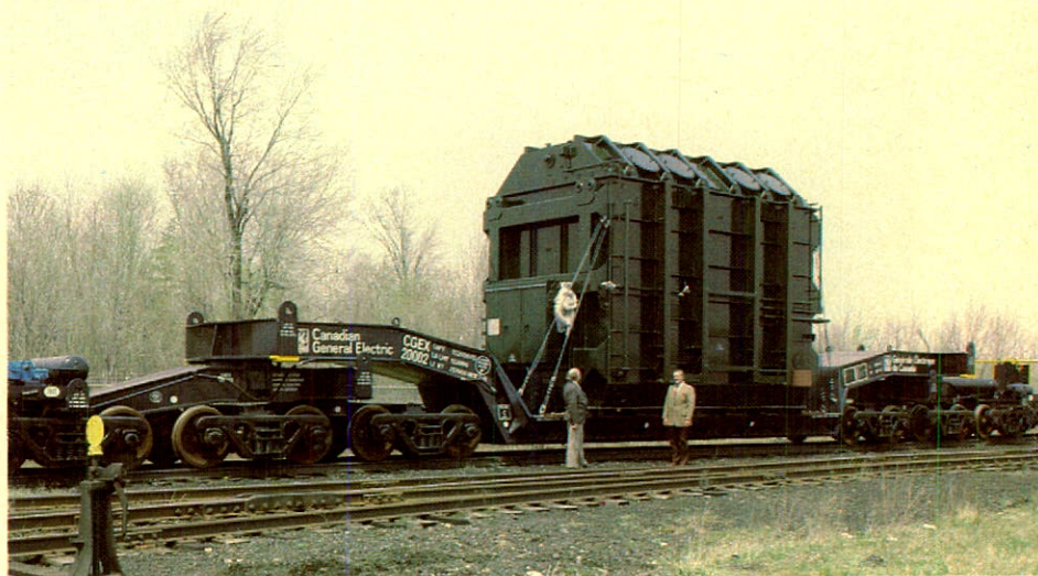
Le premier des dix transformateurs de centrale commandés par Hydro-Québec pour sa centrale LG3 de la Baie James expédié par le nouveau wagon plat surbaissé de la Section des transformateurs de puissance.
