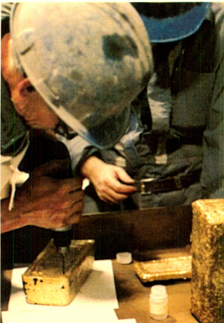
Extraction de copeaux d'or pour déterminer la teneur
