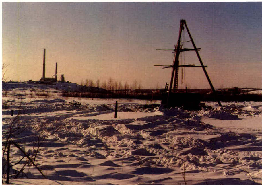
Installation de forage au diamant sur le projet Delbridge/Kerralda; à l'arrière plan, la fonderie Horne de Noranda.
