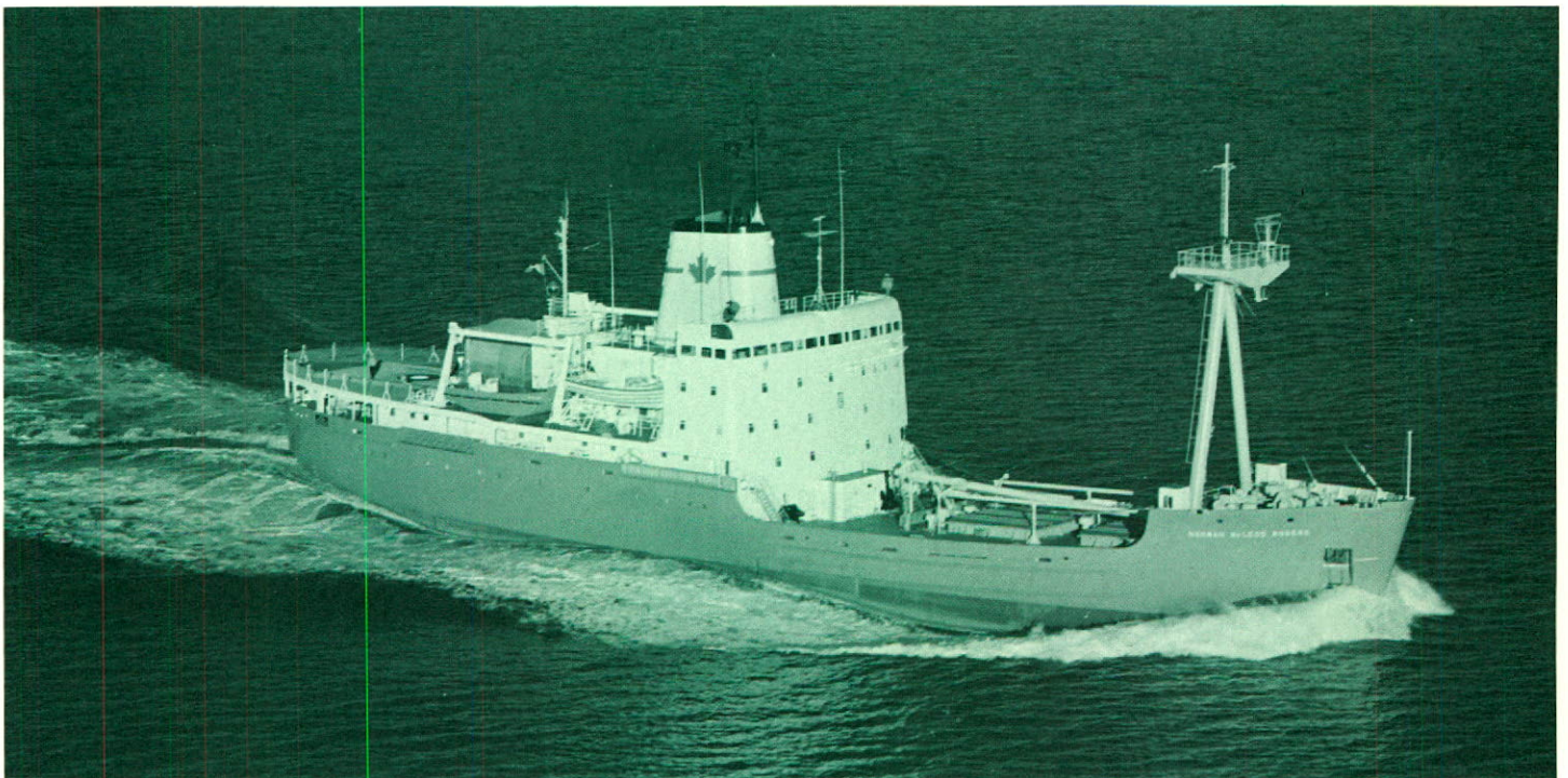
Le "Norman McLeod Rogers", de construction canadienne, est le premier brise-glace au monde à être propulsé par des turbines à gaz. Fabriquées à Hamilton, ces turbines permettent un effort additionnel pour enfoncer les glaces les plus épaisses.
