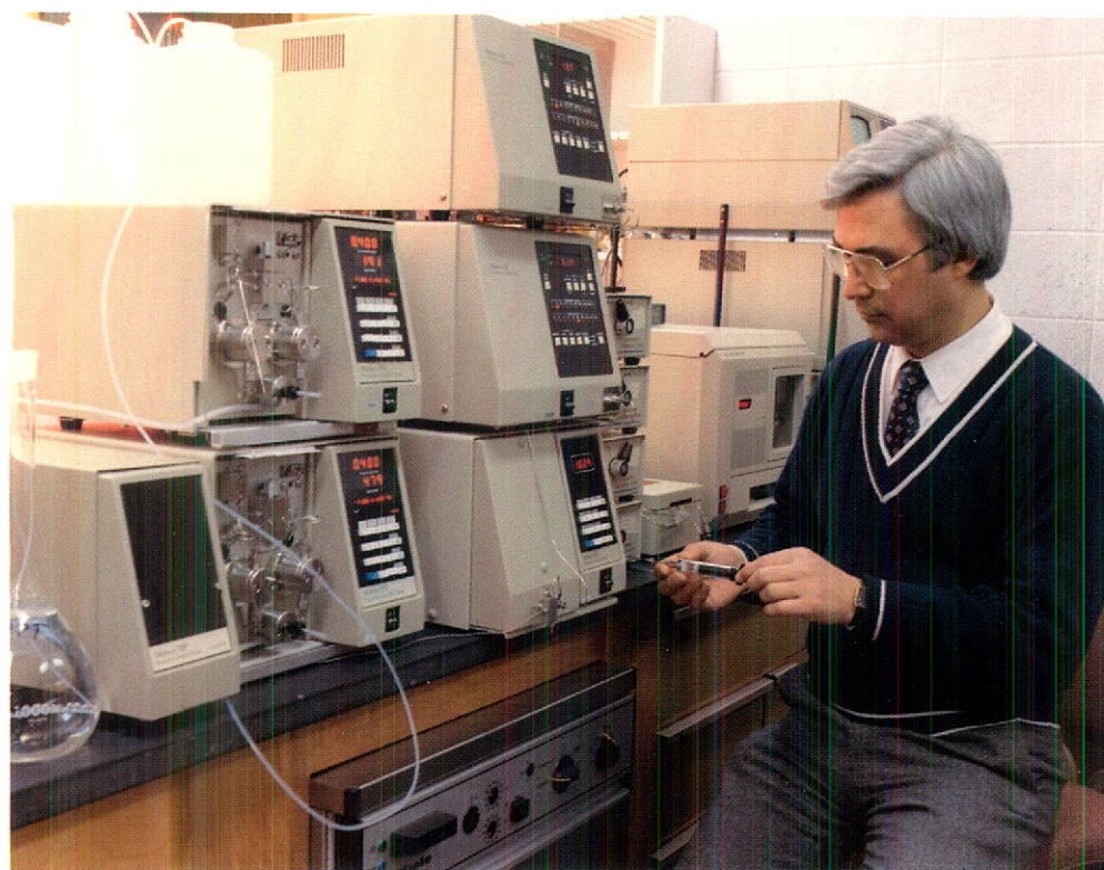
Analyse d'échantillons d'eau du cycle thermique de centrales nucléaires par chromatographie ionique à haute performance.
