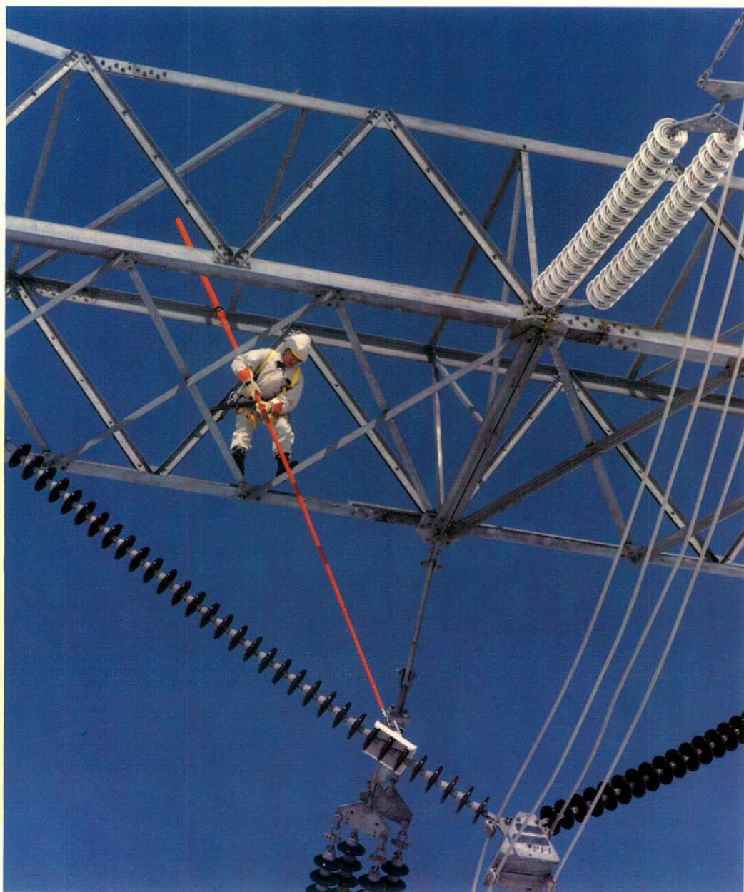
Un prototype commercial de la sonde de détection des isolateurs perforés a été mis au point cette année en collaboration avec la société Positron.
