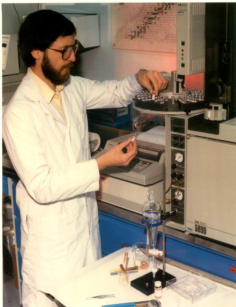
Détermination par chromatographie gazeuse du pentachlorophénol dans des échantillons de bois provenant de poteaux de distribution.
