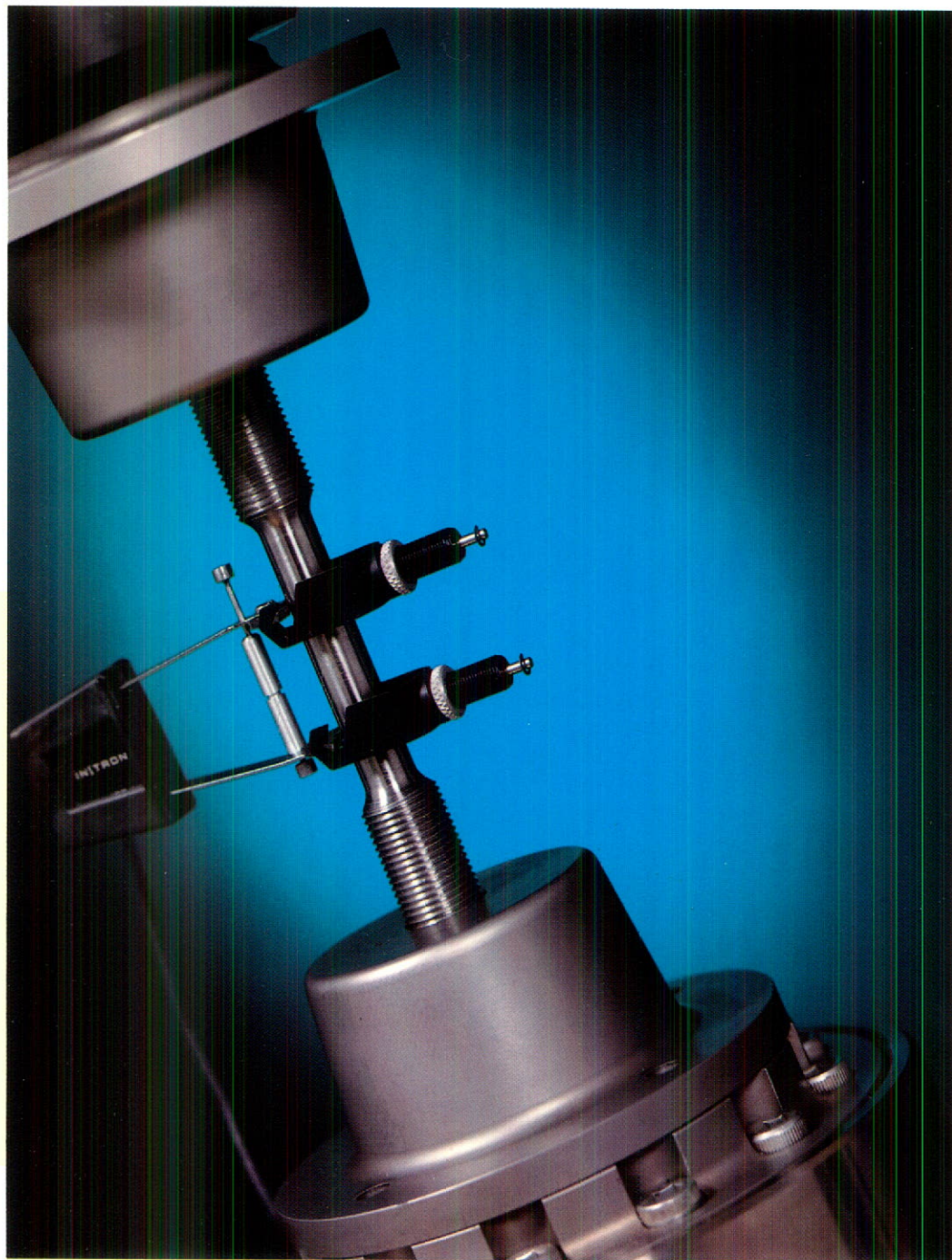
Préparation d'un essai de fatigue de l'acier d'une conduite forcée de la centrale de Bersimis 2.
