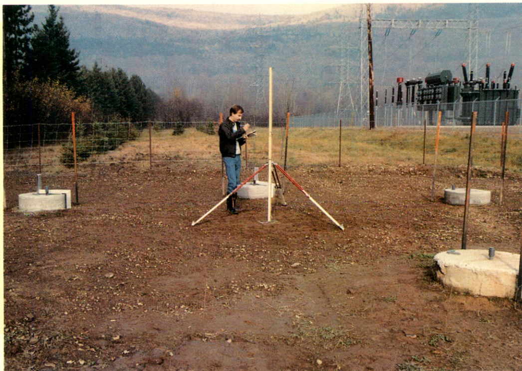
Station d'essais pour l'étude du soulèvement des fondations à action latérale par le gel adhésif du sol, située au poste Beaupré près de la ville de Québec.
