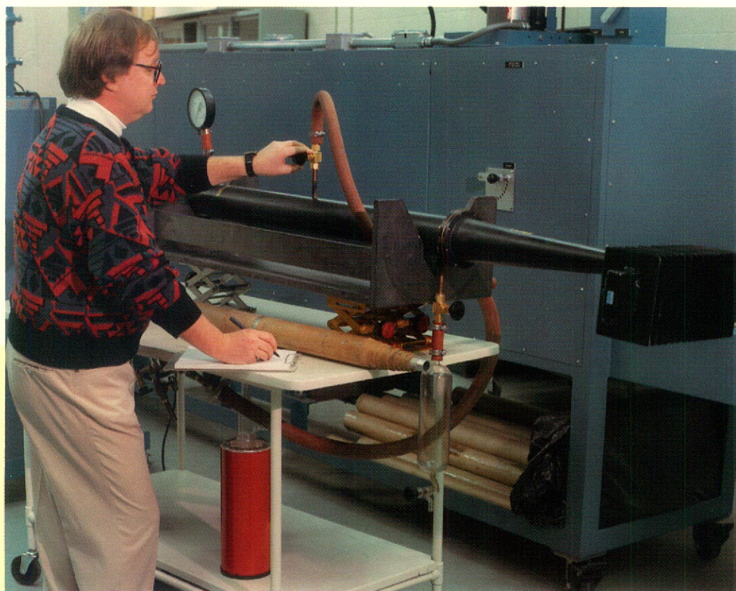
Dispositif à micro-ondes pour le séchage de traversées à 120 kV.
