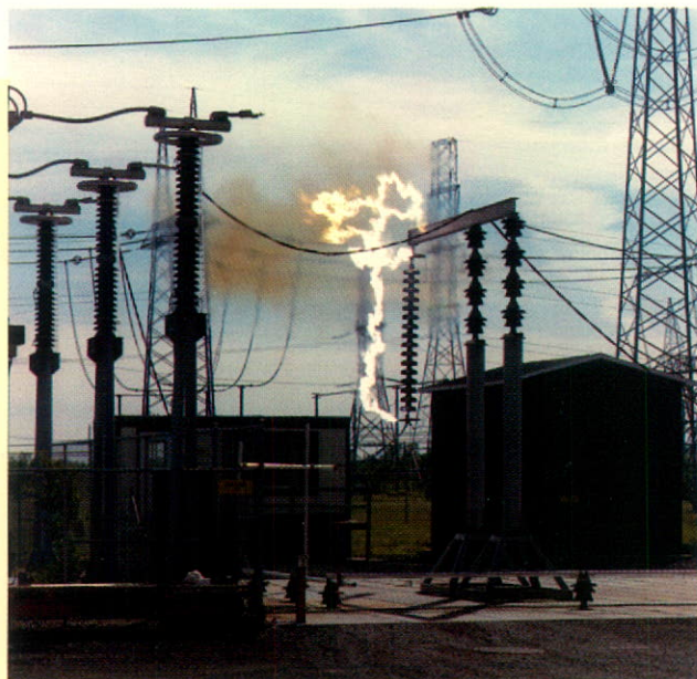
Essais au laboratoire Grande puissance sur l'extinction des arcs secondaires et le réenclenchement monophasé des lignes à 315 kV.
