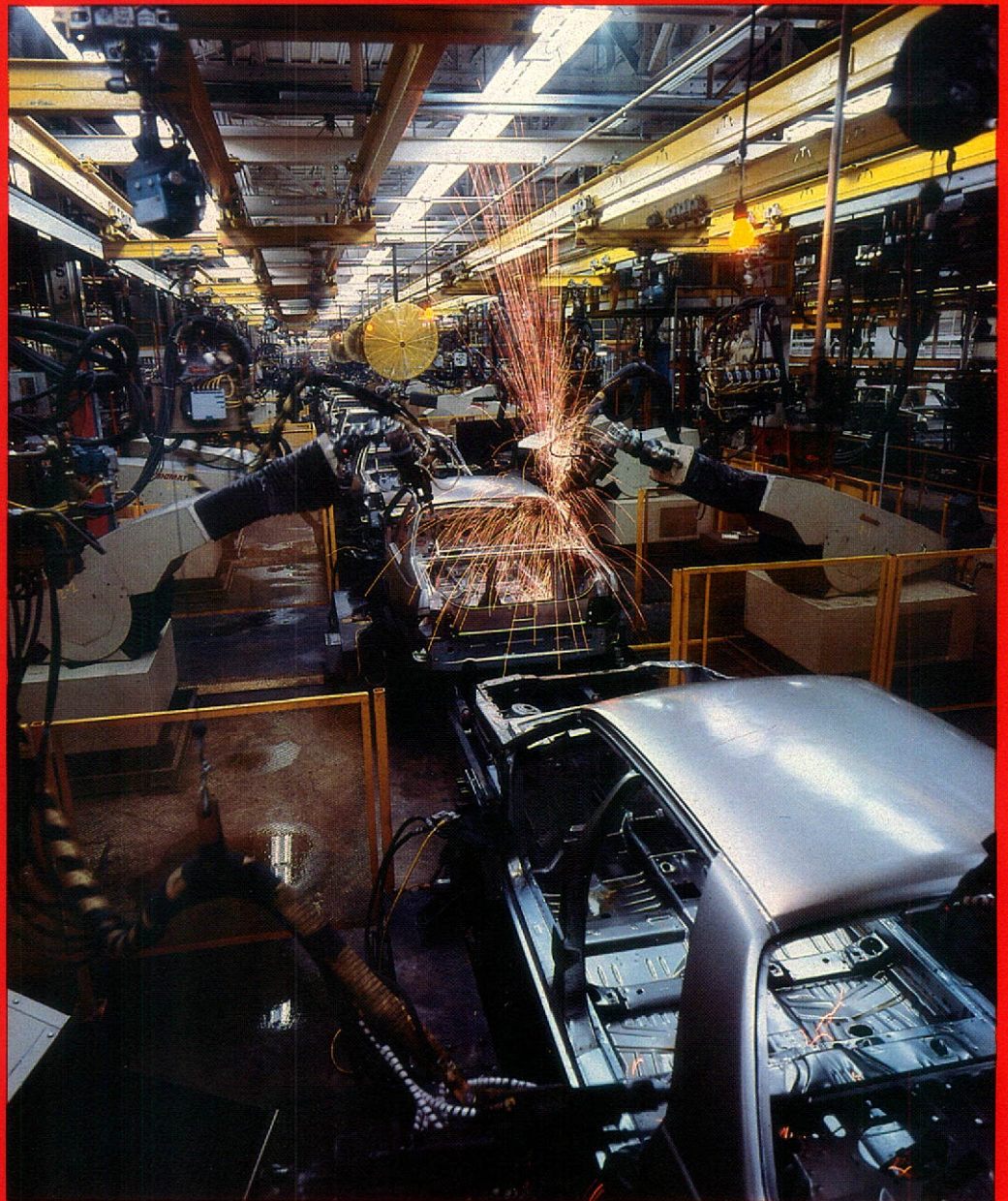
Tout équipement automatisé n'est pas nécessairement robotisé. Cet appareil servant à l'assemblage de la carrosserie fixe et soude diverses pièces de la carrosserie en une seule opération automatisée.
