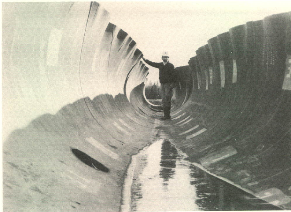
Un tronçon de tuyau crevé à l'installation d'essais de résistance des tuyaux à Rainbow Lake (Alberta).
