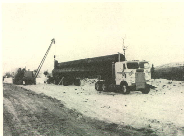
Au cours d'un essai sur route réussi, un camion-remorque spécialement conçu dont les roues arrière s'orientent automatiquement en fonction des roues avant, a parcouru la distance qui sépare Edmonton de l'installation d'essai de Quill Creek (Yukon). L'essai visait à vérifier si le nouveau véhicule pouvait transporter de longs raccords dans des virages en épingle comme il s'en trouve le long de la route de l'Alaska.
