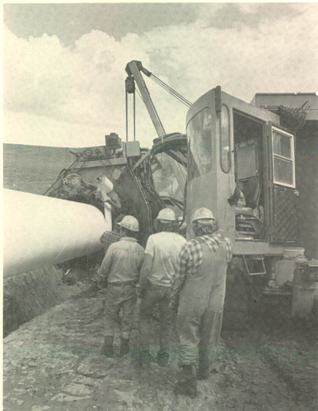
Mise à l'essai, près de Standard (Alberta), d'un prototype sophistiqué d'enrobeuse à fonctionnement hydraulique et à commandes électroniques.
