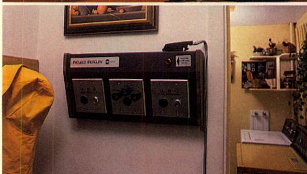
La sécurité des abonnés n'est qu'une des facettes du projet Mercury présentement en expérimentation à Saint John. Ce pupitre de commande est muni de commutateurs qui permettent aux abonnés d'entrer en communication directement avec la police, le service des incendies ou encore les services médicaux. Ce pupitre contrôle aussi un système d'alarme antivol d'une grande complexité.
