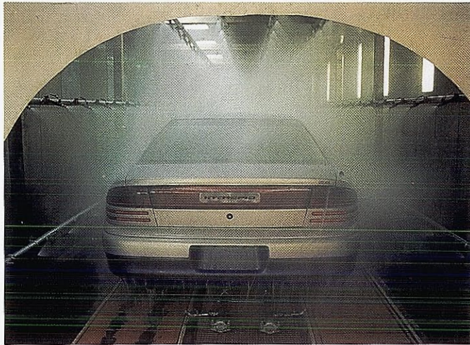
Built to take it: water leak test on Intrepid ES. Construites pour durer – essai de fuite sur une Intrepid ES.
