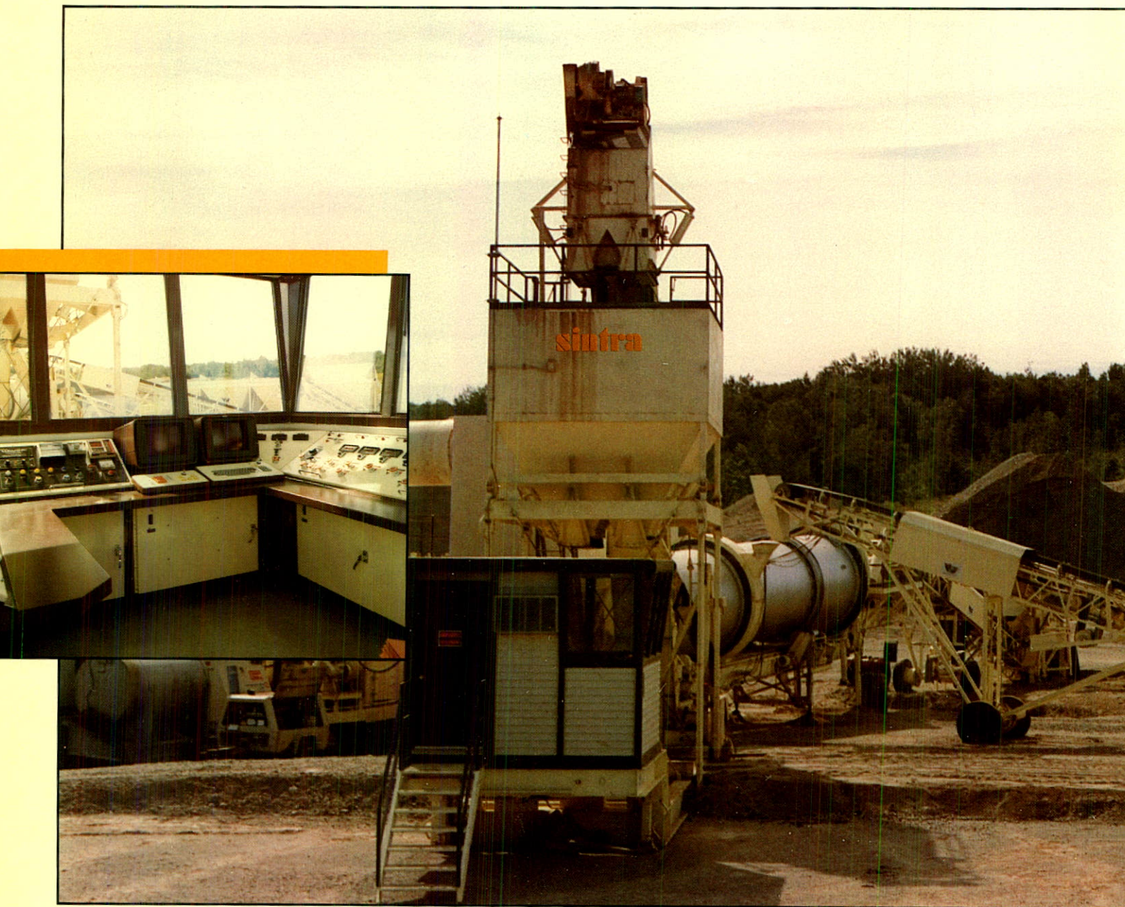
Technologie de pointe: usine type tambour sécheur malaxeur («drum-mix») entièrement automatisé. Manufacturé en totalité à Montréal selon nos exigences.
