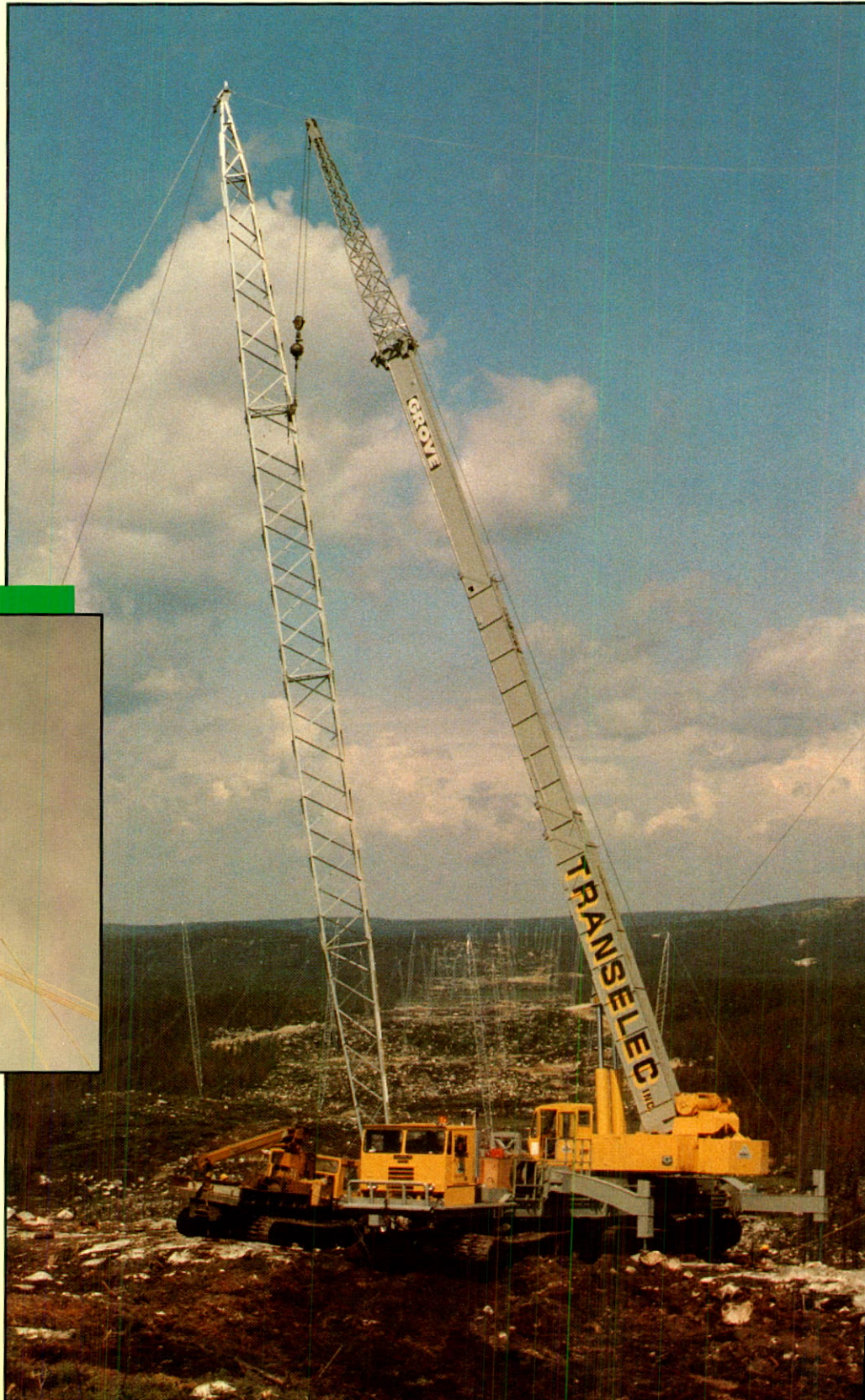
Grue télescopique tout terrain. Concept original de Transelec Inc., fabriqué à Beloeil, Québec, par «Consultants F. Drapeau Inc.»
