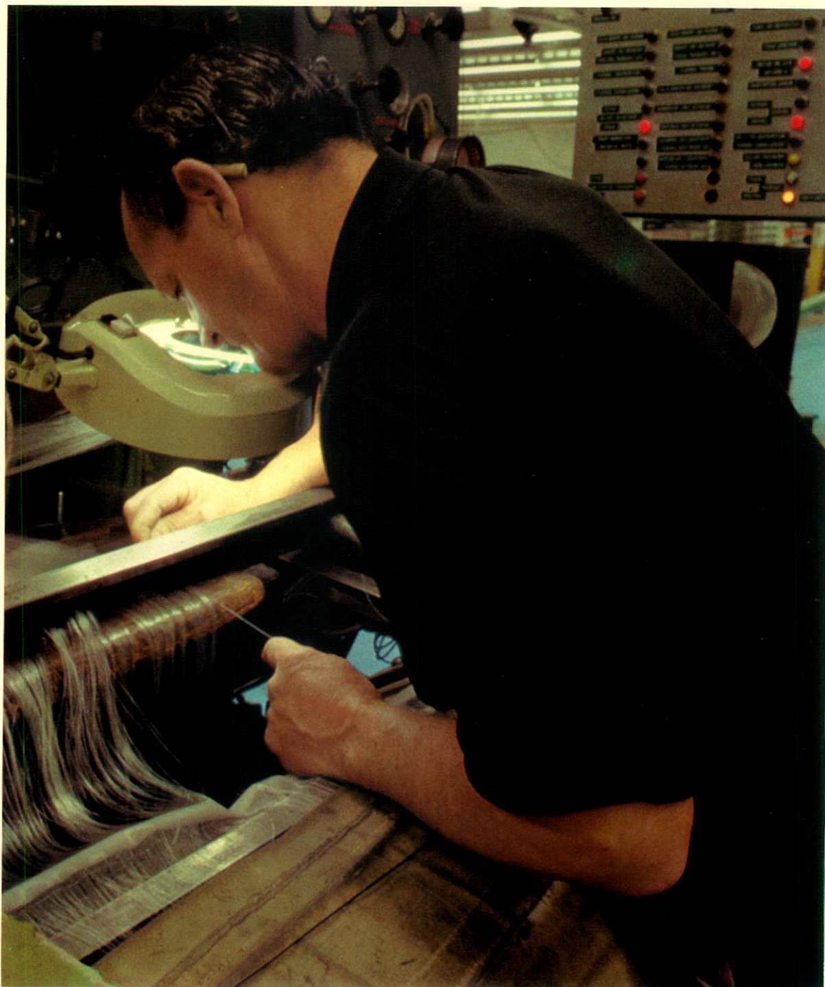
▲ Le montage sur métier d'une toile pour machine à papier exige beaucoup de minutie puisque toutes les toiles sont faites sur mesure.
