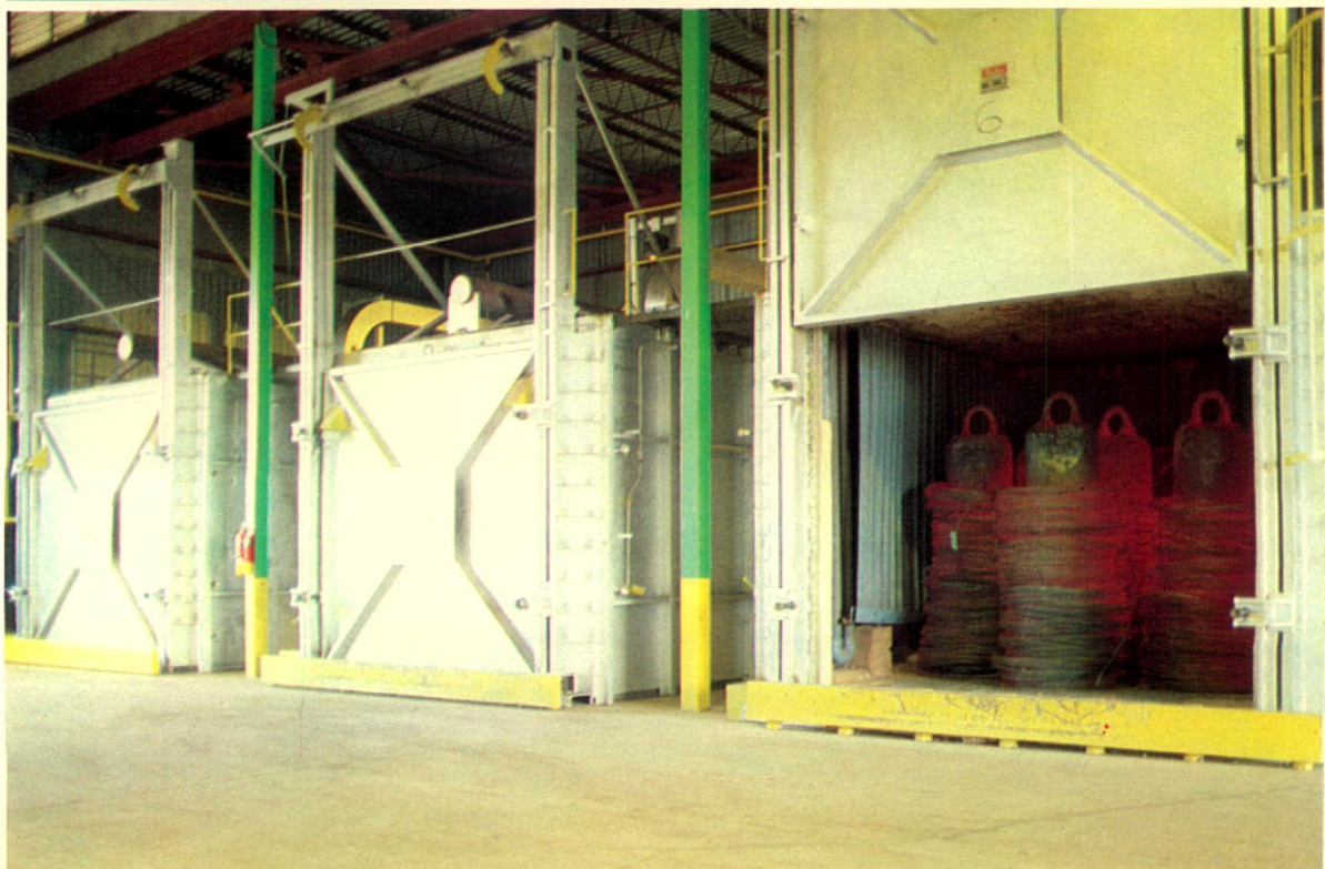
Une section de fours à recuit où le fil fini est chauffé puis soumis à un refroidissement ▲ contrôlé.
