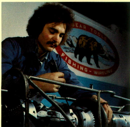
Larry Hoblack, opérateur de câble, répare un gabarit dia-log de 9 3/8\"/>
