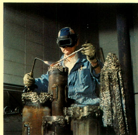
Le soudeur en chef George Ullman applique du carbure de tungstène sur la surface d'une garniture d'épurateur.
