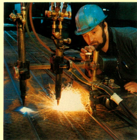
Une feuille d'acier de fort calibre est coupée en bandes.
