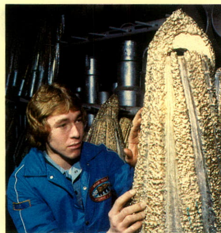
Allan Bellinger, premier manœuvre de l'usine d'Edmonton, vérifie une fraiseuse conique utilisée pour le forage à travers les sections effondrées du coffrage d'un puits.
