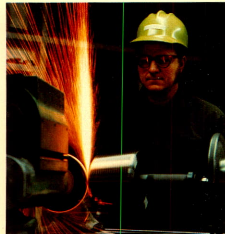
La face d'une jauge à tampon A.P.I. pour connexions rotatives est rodée à des tolérances précises par Tommy Parrish à l'aide d'une meule pour outils et ciseaux.
