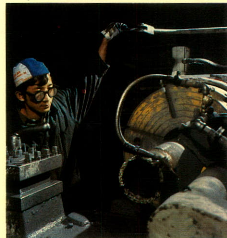
Le soudeur Nhi Nguyen rectifie les dimensions extérieures d'une garniture d'épurateur destinée à un travail spécifique.
